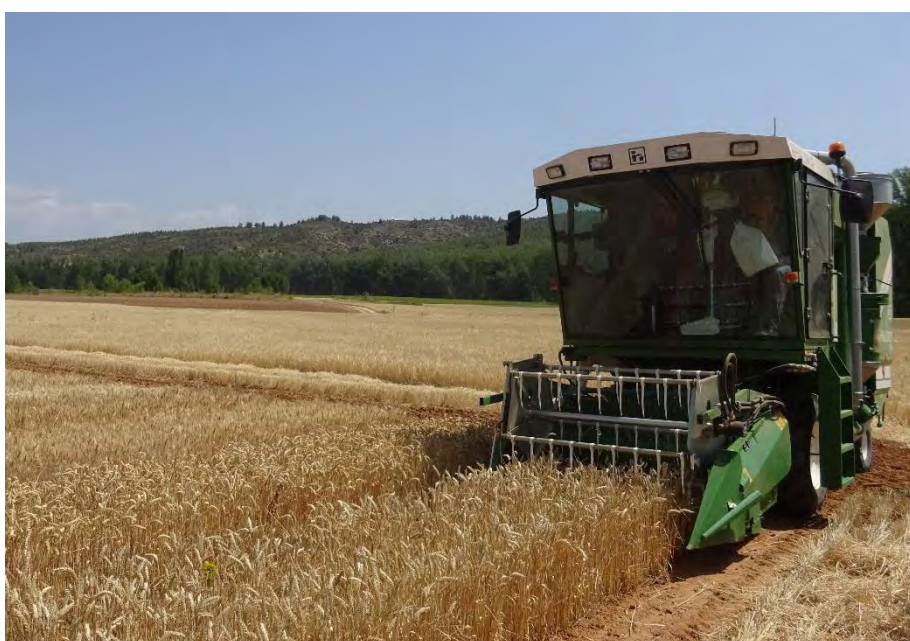
Cosecha de Microparcelas con cosechadora diseñada exclusivamente para este tipo de parcelas. CIAF Albaladejito
